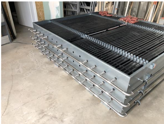
Abbildung 2: Behälter mit PCM gefüllt als Einbauteile für die Betonelemente
